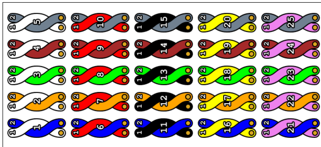
FIGURE 7.4 สาย STP ในระบบโทรศัพท์จะถูกแบ่งออกเป็นชุด ชุดละ 25 คู่สาย โดยแต่ละคู่สายจะแบ่งออกเป็น 2 กลุ่ม ได้แก่ Ring กับ Tip ซึ่งแต่ละคู่สายและแต่ละกลุ่มจะสามารถระบุได้ด้วยรหัสสีที่ถูกกำหนดขึ้นอย่างเป็นระบบ
